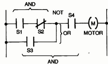
**FIG. 6—CLOSE-UP OF A SINGLE LADDER RUNG** in a ladder-logic diagram.
